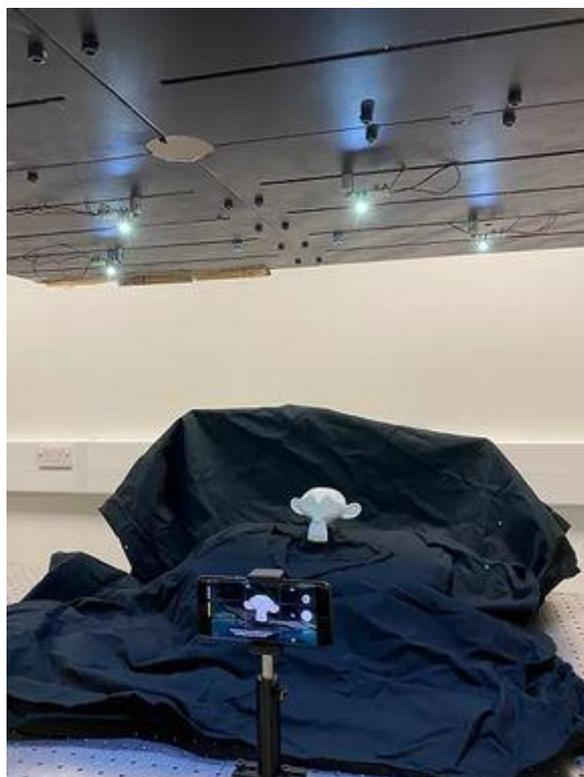
研究人员开发了一种方法，可以使用头顶的 LED 照明和智能手机来制作小工艺品的 3D 图像
